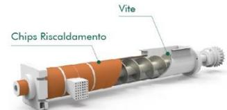
> Tecnologia di Fusione a Vite consente una maggiore densità di uscita continua con un rapporto di 90:1. Ad alta densità gli ingotti pesano fino a 25T ogni carico.
