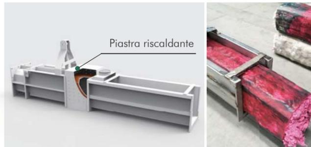
La tecnologia di fusione superficiale risolve perfettamente il problema di compressione a vite, fondendo la superficie, le schiume compattate all'interno non avrebbero espandere di nuovo.
